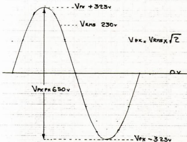
FIG 1a VOLTAGES IN A 230V RMS SINE WAVE
