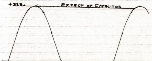
FIG 1b THE ABOVE WAVEFORM 1/2 WAVE RECTIFIED BY A PERFECT RECTIFIER
