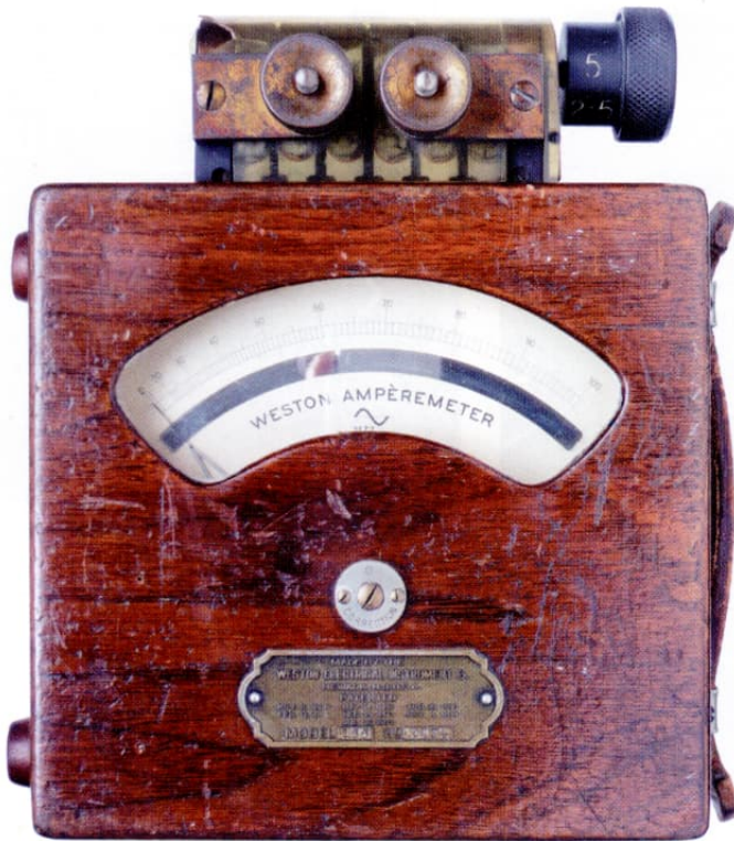
Fig 19a: Weston Ampèremeter (repulsion)
