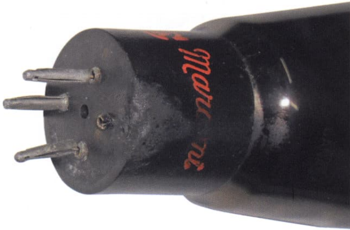
Burned-out EHT rectifier
